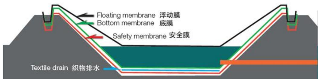
图 5.2-1 存储塘存储示意图
